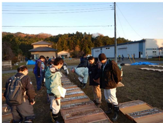
写真-2 南摩ダムのボーリングコア観察状況
