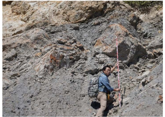
米国サンフランシスコ・ランズエンド海岸 Franciscan Complexの砂岩・泥岩の混在岩。混在岩は地質や物性の不均質性が大きく、土木工事において地質分布が不確実で「地質・地盤リスク」となりやすい。 (第13回国際応用地質学会フィールドトリップより)
